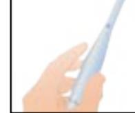
**Modo Semiautomático: Led Magenta.** Toque em um dos botões e a câmera buscará o foco. Aguarde a focalização e, para capturar e armazenar a imagem, toque novamente e mantenha pressionado por 2 segundos um dos botões
